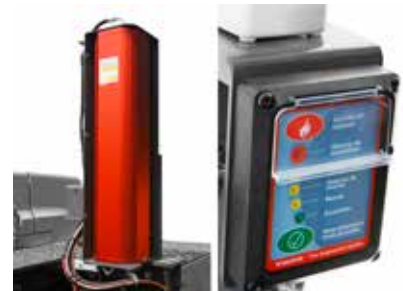
Supressão automática de incêndios
