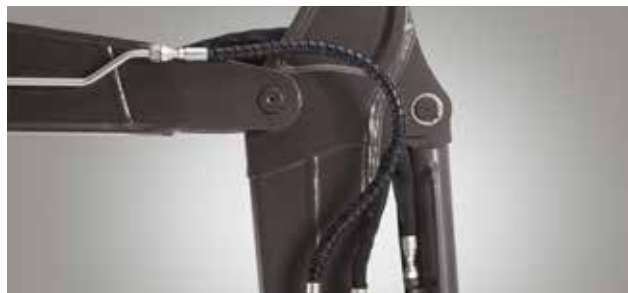
Circuito secundário para acessórios
